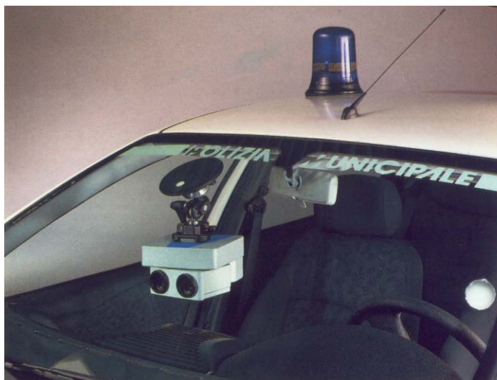
Slika 7. Način uporabe mjerila brzine ( lijevo - stacionarna montaža i desno uporaba iz automobila)
